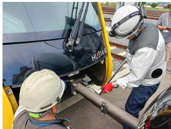
【双方の車両の連結棒を締結】
