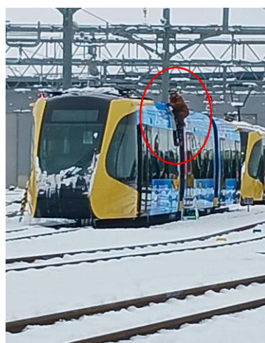
【車両屋根上の除雪の様子】
