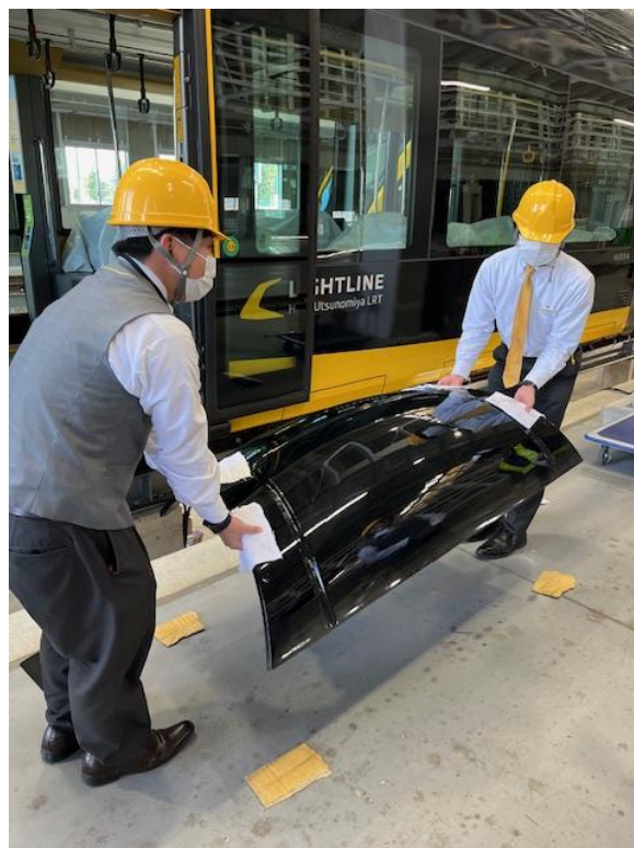
【車両前部の連結カバー外し】
