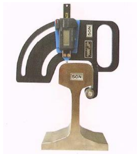
【レールの測定器具（頭面と側面）】
